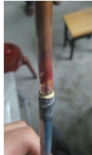
适应工艺：空调制冷阀件、冰箱冰柜管路件、太阳能配件、压缩机部件、洗衣机（管与管的连接管与外壳的连接、管与阀门的连接）、汽车配件中蒸发器和压缩机的连接、电动机的短路环等钎焊工艺。
